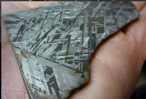
Figures de Widmanstätten sur une section de météorite de fer traitée à l'acide
