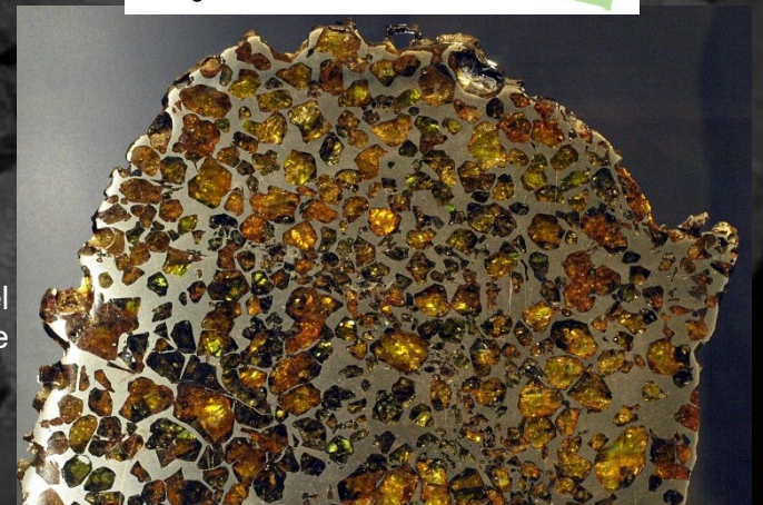
Figures de Widmanstätten sur une section de météorite de fer traitée à l'acide
